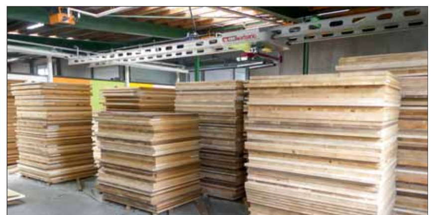
Neben individuell gefertigten Massivholzplatten wird ein breites Spektrum von Platten in Standardmaßen vorgehalten. Das Lager ist komplett automatisiert.
