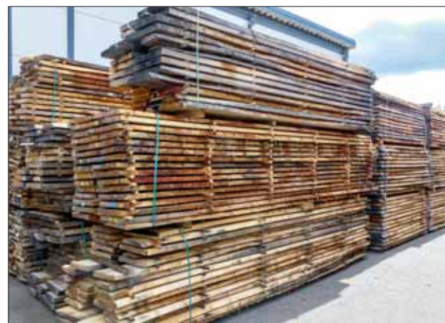
Frühestens nach eineinhalb Jahren natürlicher Trocknung kommt das Holz in die Massivholzplattenproduktion.
