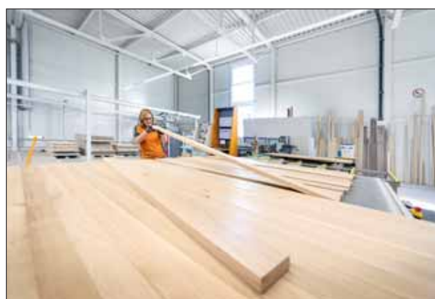
Die Lamellen werden vor der Verleimung von Hand zusammengestellt. Hier sind Können und Erfahrung gefragt.
