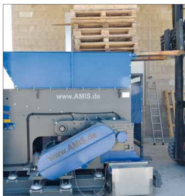
Der Trichter des Zerkleinerers ist so dimensioniert, dass ganze Stapel von Einwegpaletten eingefüllt werden können.
