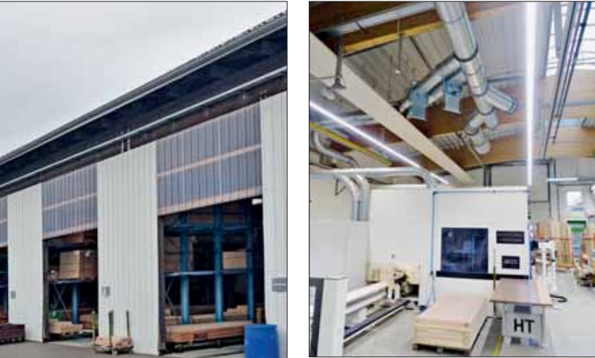
Absaugung bei einer von 90 Maschinen, hier ein Bearbeitungszentrum im Türenbau
