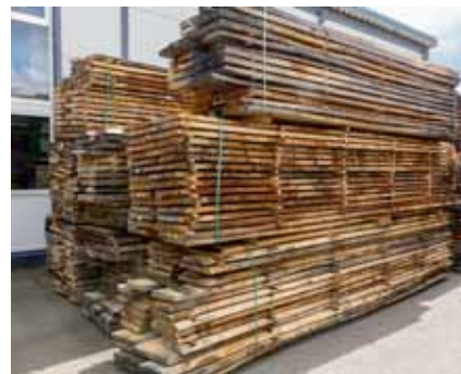
Frühestens nach eineinhalb Jahren natürlicher Trocknung kommt das Holz in die Massivholzplattenproduktion.
