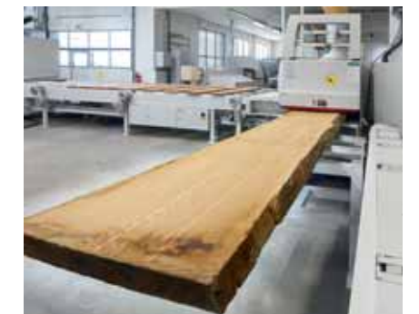
Einstieg in die Plattenproduktion ist das Aufteilen der Bretter, die Aufgabe ist einer der wenigen Handarbeitsplätze.
