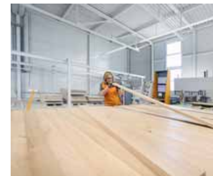
Die Lamellen werden vor der Verleimung von Hand zusammengestellt. Hier sind Können und Erfahrung gefragt.
