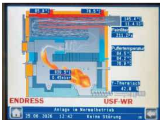
Die Kesselsteuerung visualisiert den Anlagenaufbau und die aktuellen Betriebszustände
