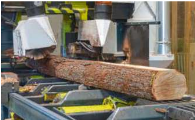
Blockbandsägen schneiden dünne Bretter. Die Holzfeuchte liegt meistens bei weit über dem Fasersättigungspunkt bei rund 30 %
