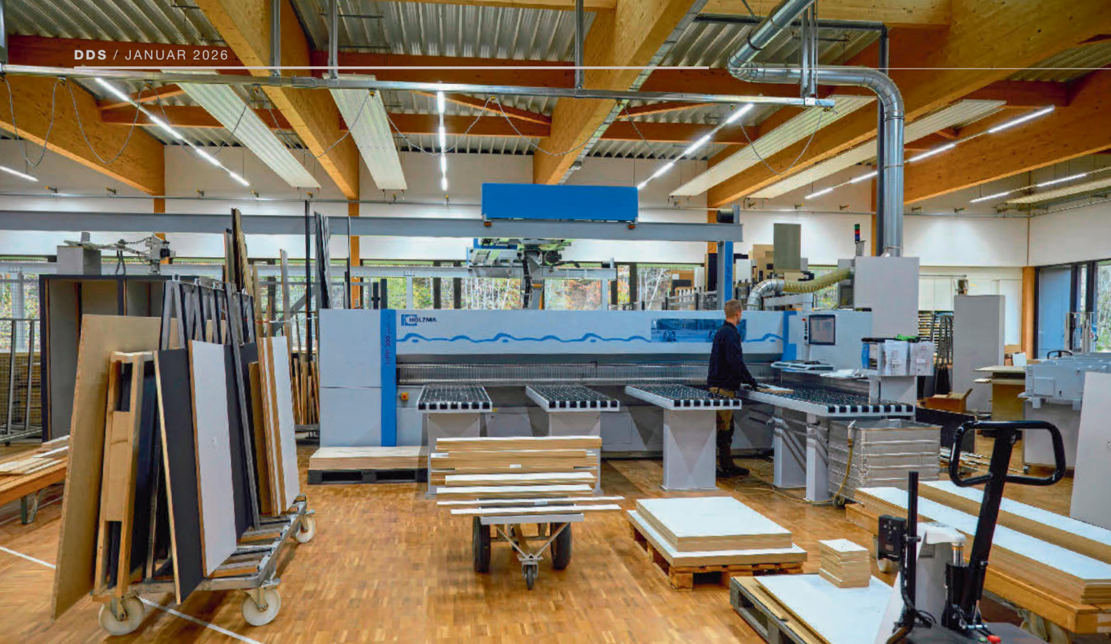
Auf aktuellem Stand der Technik: Diese für die Lager-Säge-Kombination, die Kantenanleimmaschine sowie die CNC-Maschinen angebaute Halle hat den Wärmebedarf der Schreinerei nach oben getrieben, was dann auch für die Ersatzinvestition des Heizkessels sprach
