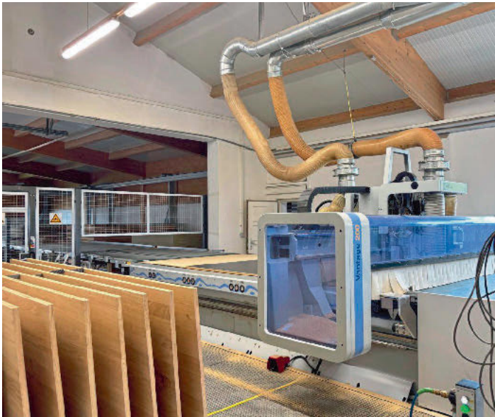
/ Die Nestingmaschine Vantage 200 von Homag mit automatischer Lager-Rückführung ermöglicht präzise Zuschnitte und kurze Wege zwischen Lager und Fertigung.
