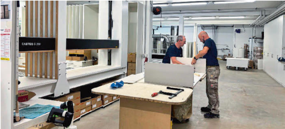
/ Im Bankraum montieren die Mitarbeitenden jedes Möbelstück sorgfältig von Hand, unterstützt von der vielseitigen Korpuspresse Homag Cabteq S-250 für perfekte Verbindungen.
