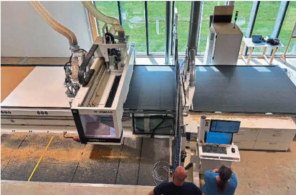
/ Die Homag Nestingmaschine Centateq N-700, direkt an das Plattenlager angebunden, ermöglicht in dem lichtdurchfluteten Gebäude in Holzbauweise eine hochautomatisierte Produktion.
