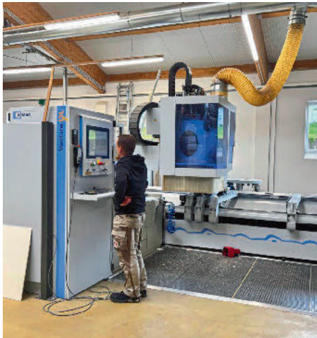
/ Für eine vielseitige Weiterbearbeitung der Platten kommt die CNC Homag Venture 13L zum Einsatz.
