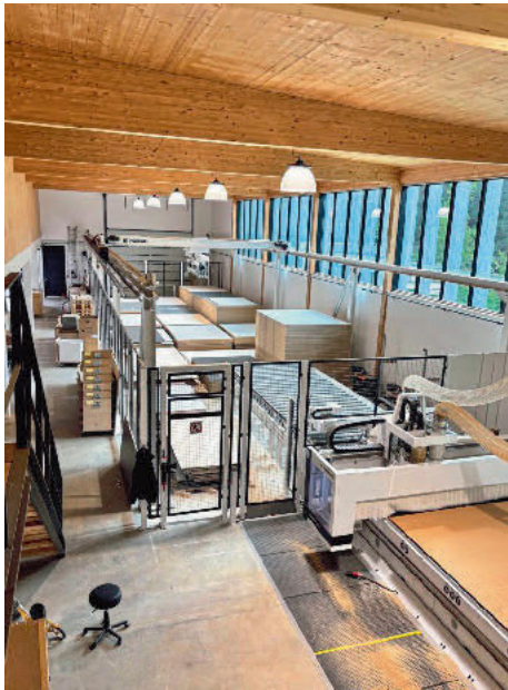
/ Ein automatisches Plattenlager mit Rückführung schafft in Werk 2 optimale Materiallogistik.
