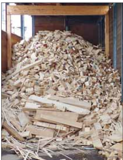
Neben Hobel- und Sägespänen dienen stückige Reste aus der Leimbinderproduktion als Brennstoff, die von einem externen Unternehmer gehackt werden.
